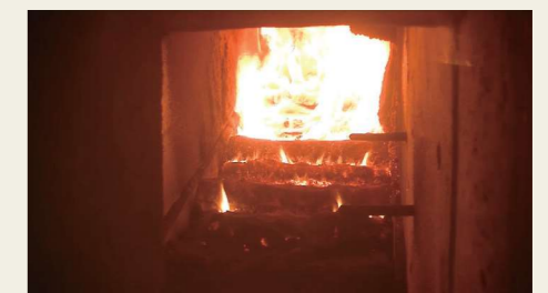
写真1 炉内で燃焼中の汚泥
