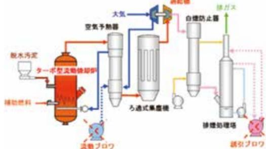
図-1 ターボ型流動焼却炉の設備フロー
