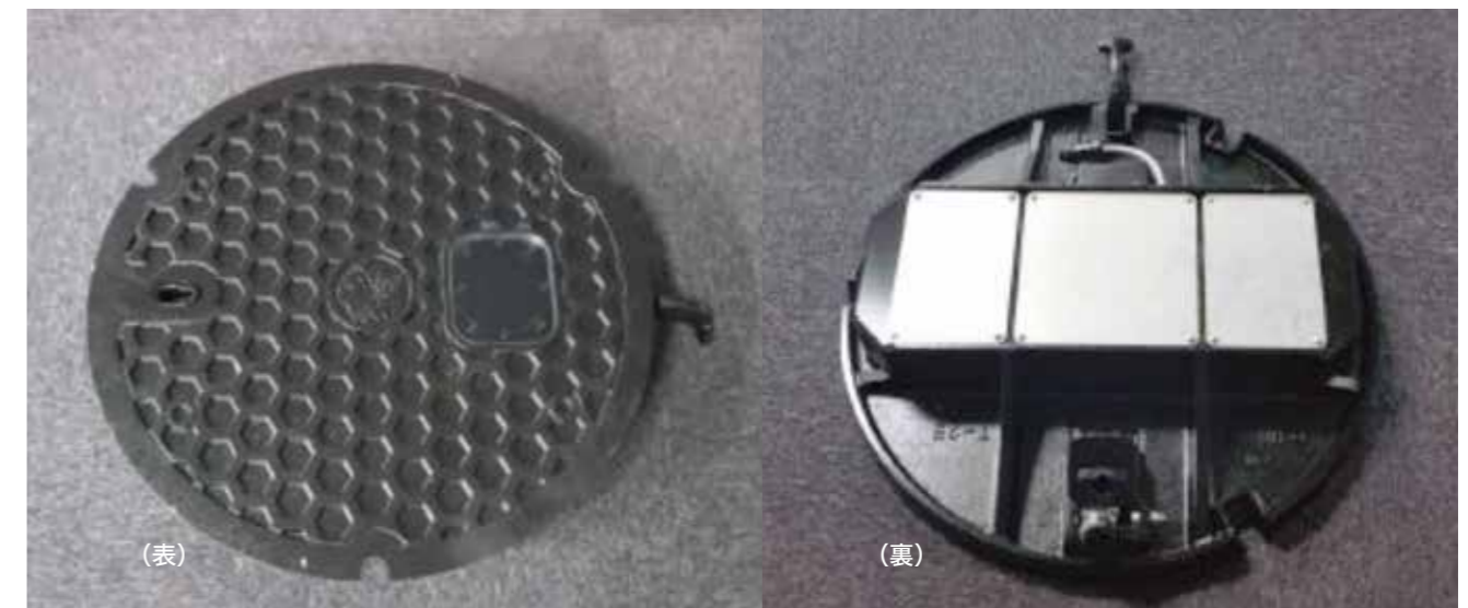
図-2 マンホールアンテナ
