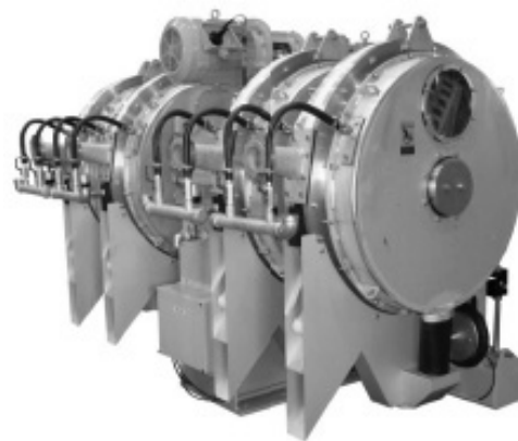
図6-6-2 回転加圧脱水機の外観
