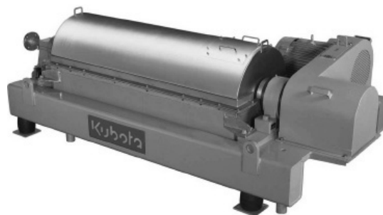
図6-3-4 直胴型遠心脱水機の外観
