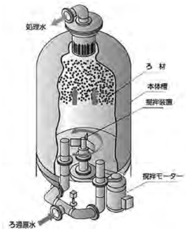
図 11-1-7 高速繊維ろ過装置
