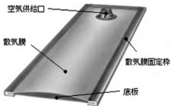
図3-2-4 メンブレンパネル式散気装置の構造①
